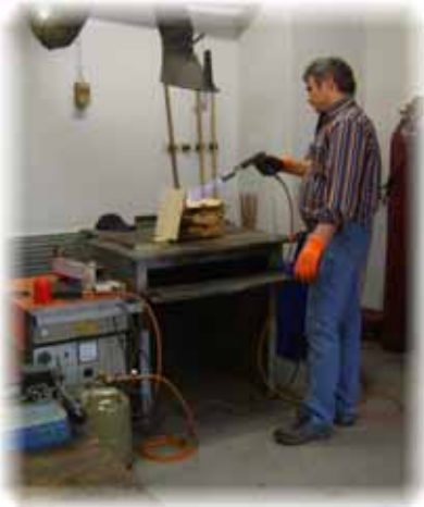
Das Foto zeigt das fachmännische Abflammen eines Kastens in der Werkstatt
